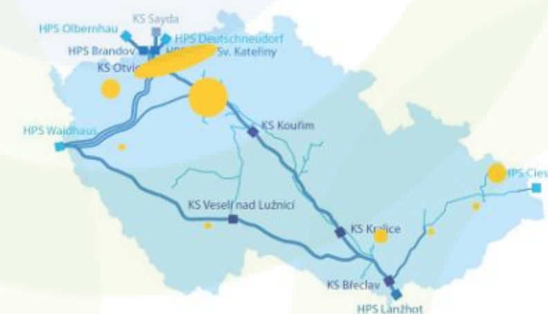
Obrázek 9.2: Oblasti možné spotřeby vodíku a jejich umístění ve vztahu k přepravní soustavě
